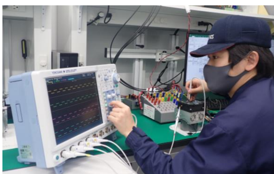
ESC モジュールの電子回路解析
