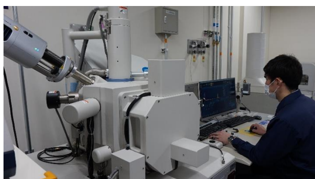
電子顕微鏡による材料表面の形態解析
